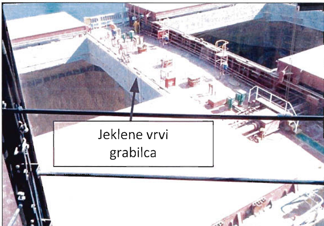
Slika 15: Pozicija zajemanja tovora v času nesreče - lega grabilca
