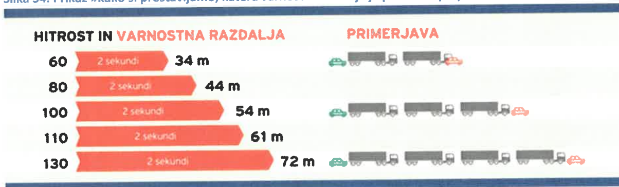
Slika 34: Prikaz »kako si predstavljamo, katera varnostna razdalja je potrebna pri posamezni vozni hitrosti«
