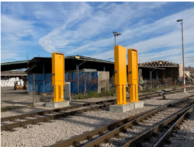
Slika nekaterih portalov za spremljanje radioaktivnosti pošiljk v pristanišču
